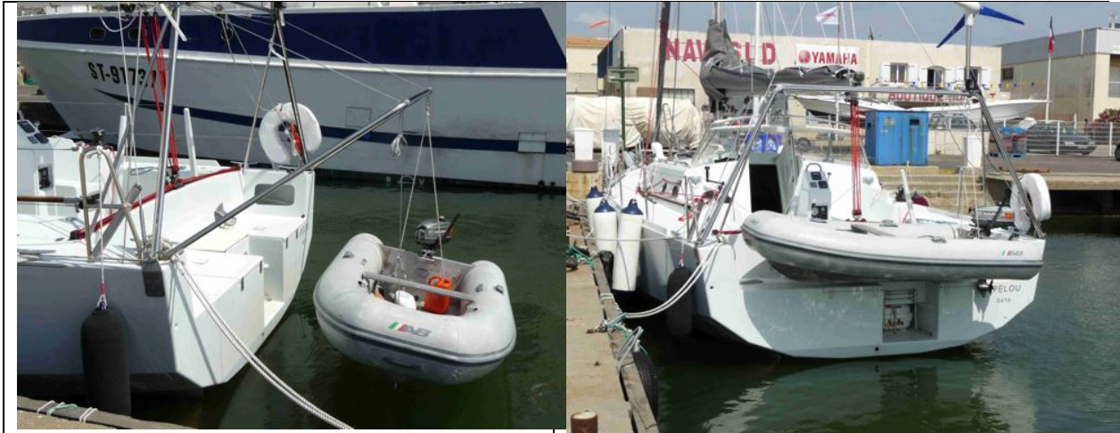
Le portique pour l'annexe
